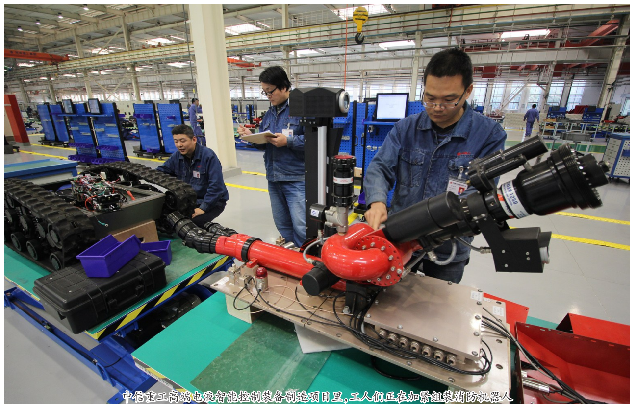
中信重工高端电机智能控制装备制造项目里,工人们正在加紧组装消防机器人
